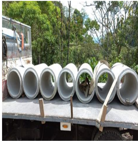
Adquisición de alcantarillas de concreto
